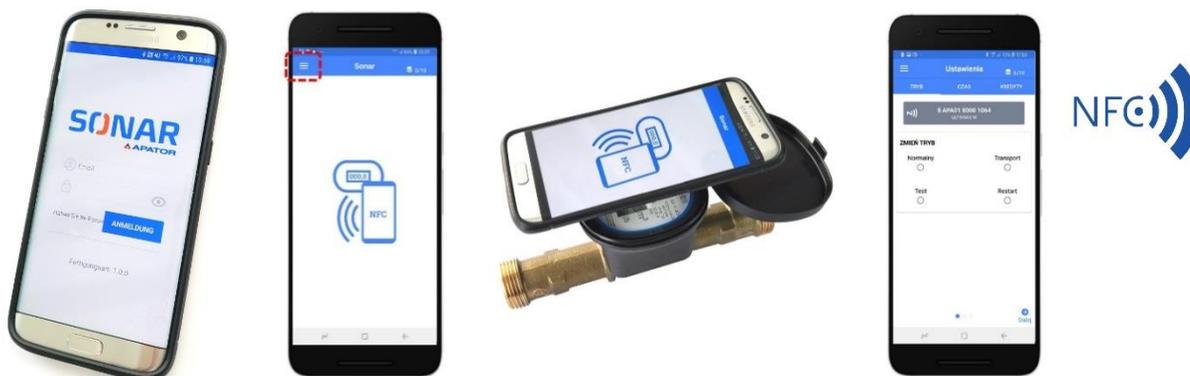
Nach einem erfolgreichen Zugang zum Zähler kann der SONAR APP Anwender nun zwischen den 3 Betriebsmodi wählen: 1. Normal-Mode (Standard Betrieb), 2. Transport-Mode (Sleep) und 3. Test Mode (Prüfmodus). Zusätzlich kann ein Zähler-Restart (inkl. Displaytest) wahlweise durchgeführt werden (Zählerstände bleiben erhalten). Mit der SONAR APP ist auch die Auslesung des Datenloggers (400 Tage) und der Alarme möglich.
